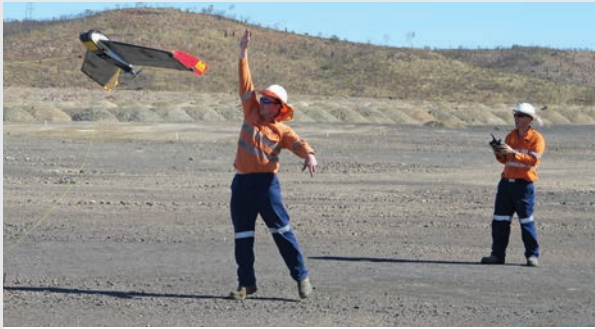
Century矿山放飞无人机来捕捉热成像并监测废石场
