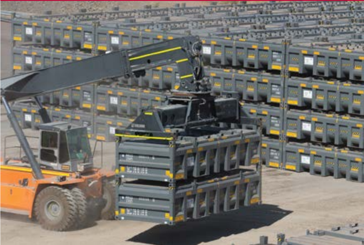
图片：澳大利亚杜加尔河矿山的精矿集装箱
