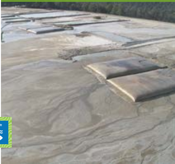
图片：澳大利亚罗斯伯里矿山的土工管袋充填试验
